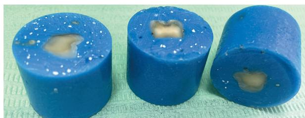
▲ **Рис. 2** Образцы для проведения испытаний прочности адгезионного соединения – шлифы зубов, зафиксированные в пластмассовом блоке
