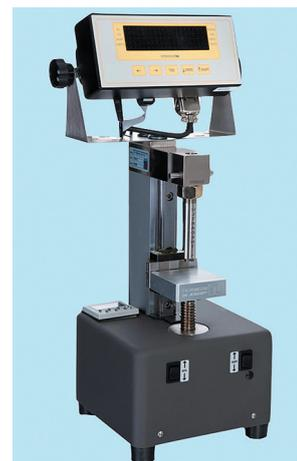
▲ Рис. 5 Испытательный аппарат UltraTester Bond Strength Testing Machine
