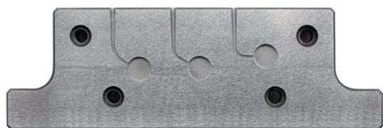
▲ Рис. 1 Вид специально изготовленного блока с каналами из нержавеющей стали для проведения циклических испытаний на усталость
