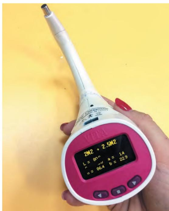
▲ Рис. 5 Определение цвета образцов после окрашивания в течение 6 ч при помощи спектрофотометра EasyShade Advance
