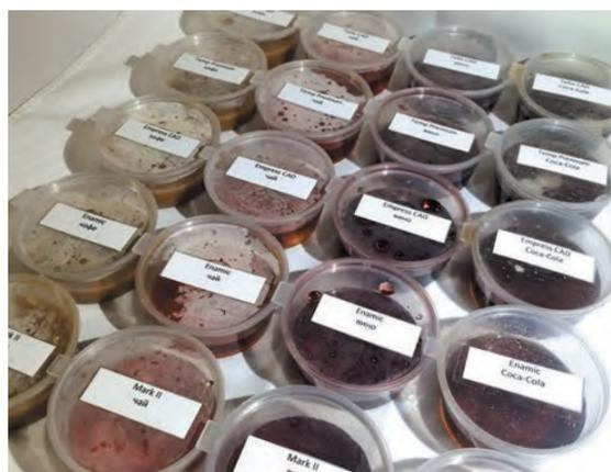
▲ Рис. 4 Проведение испытания стойкости к окрашиванию
