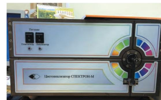
▲ Рис. 3 Цветоанализатор «Спектрон-М»
