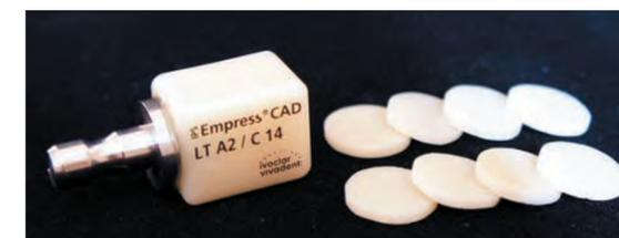
▲ Рис. 1 Вид образцов для определения стойкости к окрашиванию на примере материала из лейцитной стеклокерамики IPS Empress CAD
