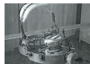
◀ Рис. 4 Регистрирующее устройство на артикуляторе шарнирно-эллипсного типа с «Т-образной памятью» и сориентированными гипсовыми моделями
