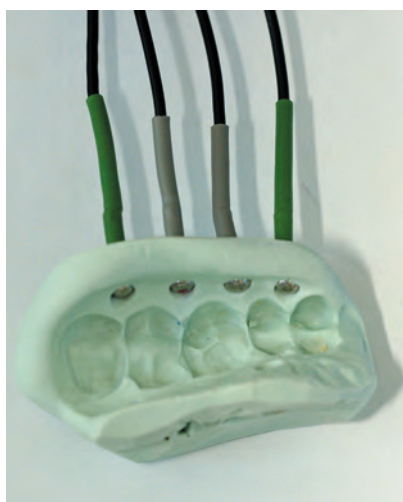
▲ Рис. 2 Расположение датчиков в силиконовом позиционере
