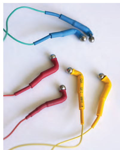
▲ Рис. 3 Датчики электродной системы для ВРПГ
