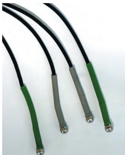
▲ Рис. 1 Датчики электродной системы для СРПГ
