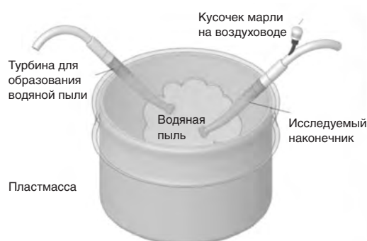
▲ Рис. 3 Испытательная установка для проверки наличия обратного всасывания: условие появления водяной пыли
