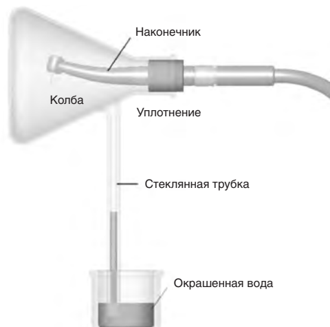
▲ Рис. 1 Испытательная установка в собранном виде: измерение давления обратного всасывания всей головки наконечника
