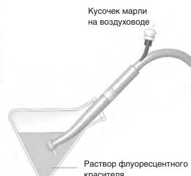
▲ Рис. 5 Проверка наличия обратного всасывания: испытательная установка для полного погружения
