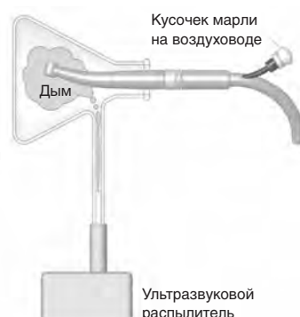
▲ Рис. 4 Испытательная установка для проверки наличия обратного всасывания: условие появления дыма
