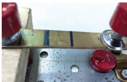
▲ Рис. 2 Внешний вид образца базисов зубных протезов из пластмассы «Фторакс» с покрытием карбидом кремния «Панцирь» толщиной 1600 нм, размером 80 x 10 x 2 мм, с маркировкой центрального (1) и периферического (2) участков исследования
