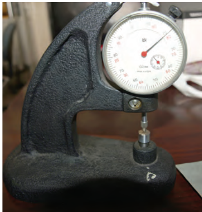
Рис. 2 Измерение толщины образцов сплавов микрометром
