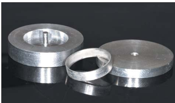
Рис. 1 Части, формирующие матрицы, с видимым кольцом и центральным штифтом
