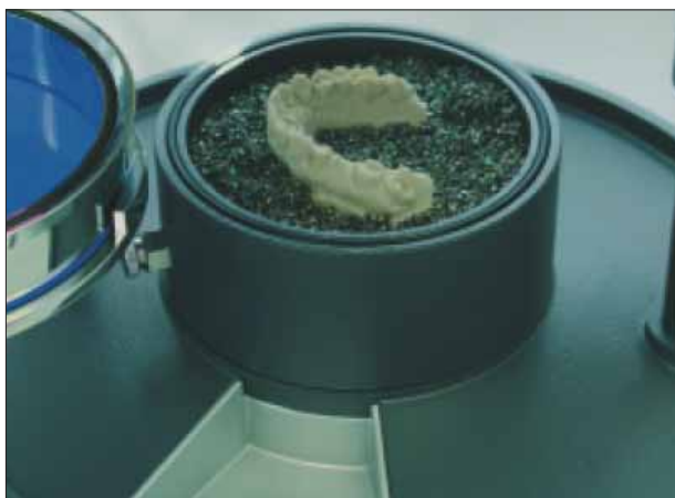
РИС. 8 Вид модели, запечатанной в чаше с гранулятом прибора для техники печатных форм
