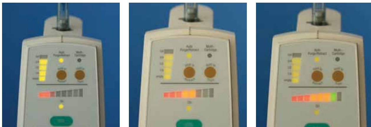
РИС. 3 На передней панели базового блока находится шкала давления, состоящая из последовательно расположенных LED-указателей:
