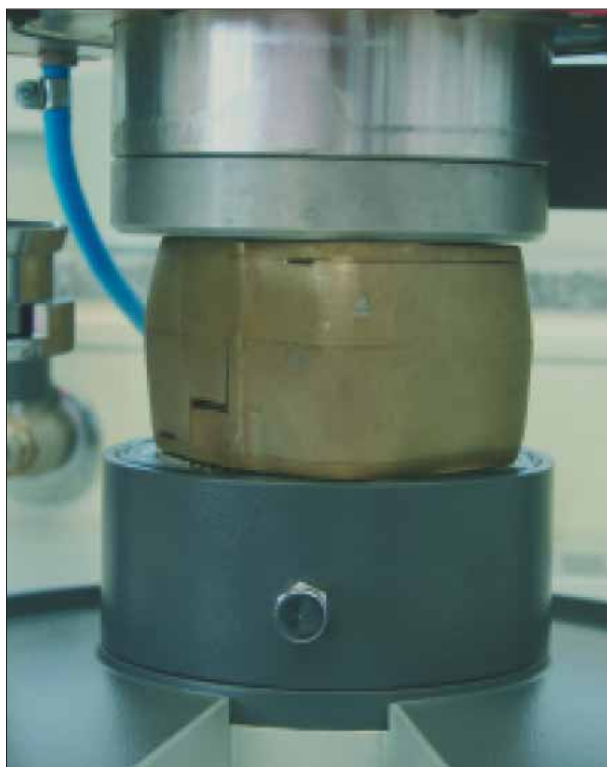
РИС. 3 Drufoformat scan с интегрированной насадкой для прессования и кюветой во время пневматического процесса прессования
