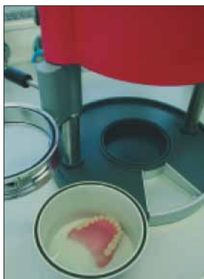
РИС. 5: Емкость для полимеризации с размещенным протезом, заполненная водой, которую удобно и просто можно поместить в многофункциональный прибор
