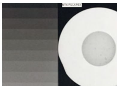
Рис. 3 Сравнительный анализ оптической плотности материала MTA Fillapex и алюминиевого клина-эталоны
