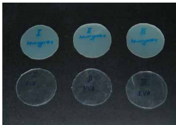
РИС. 3 Образцы для определения водопоглощения
