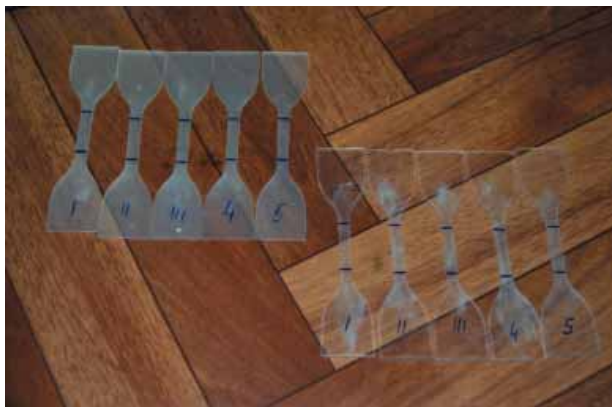
РИС. 1 Образцы для исследования упругопрочностных свойств
