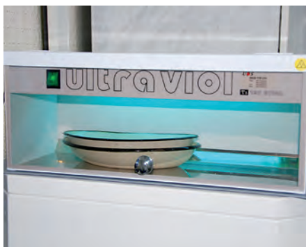
РИС. 9 Ультрафиолетовый блок с набором инструментов
