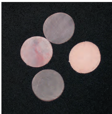
РИС. 1 Образцы пластмасс на основе нейлона, полиформальдегида, полиуретана и полиметилметакрилата
