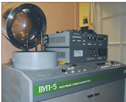
РИС. 6 Универсальный вакуумный пост ВУП-5
