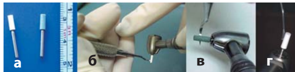
Рис. 8 Заточка инструментов с помощью наконечника и цилиндрического абразивного полира
