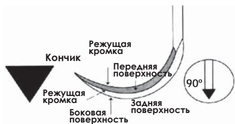
Рис. 2 Строение рабочей части скалера
